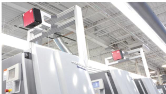
Le système EyeC ProofRunner Sheetfed HDM est un dispositif de contrôle intégré conçu spécialement pour la presse **Heidelberg Speedmaster XL 106**. Il vérifie **la qualité des notices durant leur impression** et offre aux imprimeurs une solution économique et flexible pour améliorer leur qualité et réduire leurs coûts de production.
